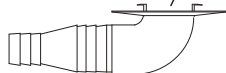
Adaptador do condensador. Encaixar no orifício na base da unidade. Posição aproximada apresentada.
